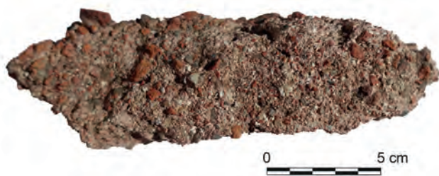
Fig. VI.2-53 - L'enduit hydraulique peut présenter de grosses inclusions de tuileau et de gravier ou, majoritairement, de petites inclusions inférieures à 2 mm de tuileau, de cailloutis ou de chaux © Cliché L. Déodat 2023.
