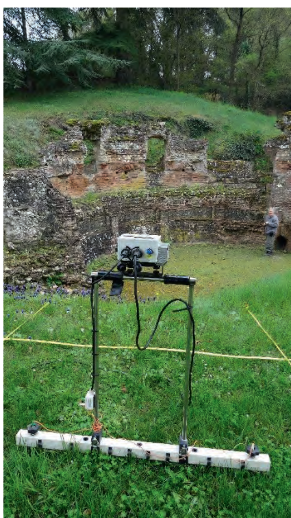
Illustration ii : Châssis du résistivimètre RM85 (Geoscan Research) avec deux électrodes et deux autres positionnées à l'infini. Cliché : Guillaume Bruniaux.
