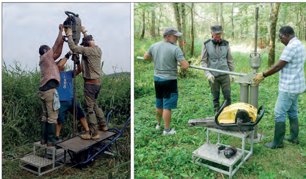
Fig. V-13 – Enfoncement (à gauche) et extraction (à droite) des carottiers © Cliché P. Thonniet 2023.
