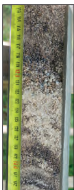
Fig. V-14 – Litage oblique dans la carotte GEN1 © Cliché P. Thonniet 2023.
