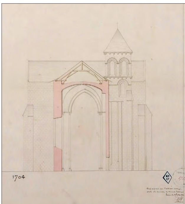
Fig. VII.4.1 - Coupe de la nef de l'église Saint-Vétérin en 1850 par Charles Joly-Leterme (MPP, Gennes).
