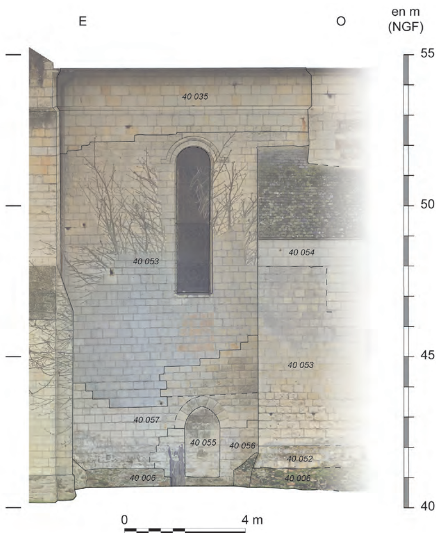
Fig. VII.4.14 - Orthophotographie interprétée du mur nord de la deuxième travée (d'après relevé photogrammétrique de D. Morleghem).
