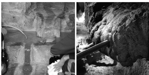
Figure 1. Deux lieux de prélèvement de concrétions calcaires : le regard Saint-Martin, appartenant au réseau des sources du Nord, et le regard XIII de l'aqueduc de Rungis
