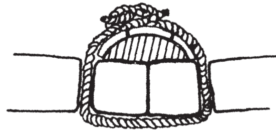
Figura 12. Schéma représentant un point d'assemblage par ligatures indépendantes, traversant de part en part l'épaisseur du bordé, employé dans la construction des bateaux cousus de l'Océan Pacifique (tiré de Manguin 1985).
