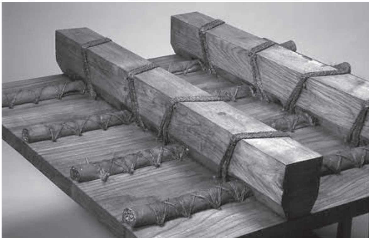
Figura 3. Modèle d'étude, à l'échelle 1, d'une section du navire romain de Comacchio (réalisation S. Marlier, R. Roman, CNRS/CCJ) (photo: Ch. Durand, CNRS/CCJ).
