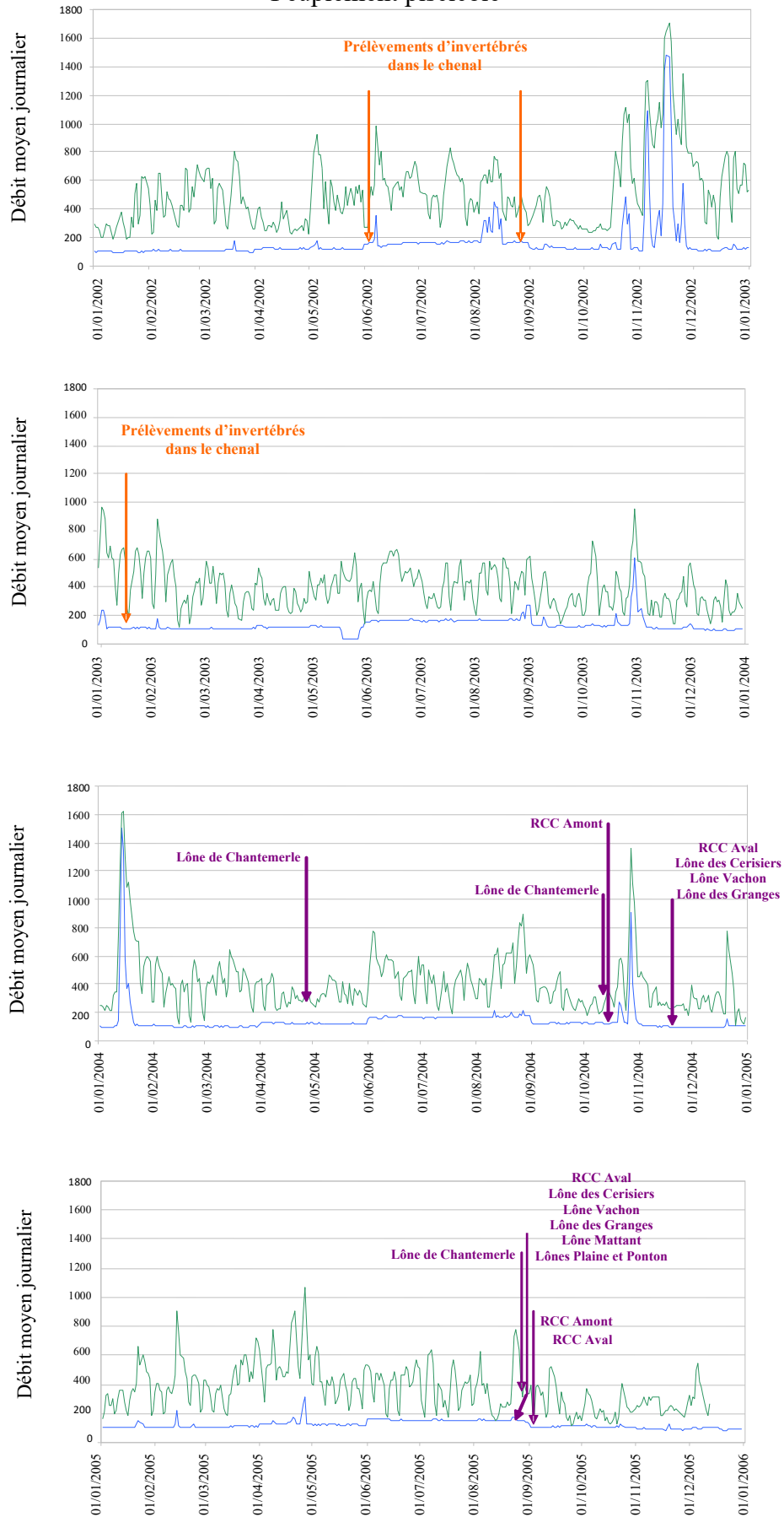
Figure 2 : Débit moyen journalier du Haut Rhone mesuré à Pont de Cordon (en bleu) et Pont de Groslée (en vert) sur la période 2002-2005. Les dates de prélèvement de la faune piscicole et invertébré sont indiquées par une flèche (orange pour les invertébrés et violette pour la faune piscicole).
