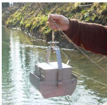
Figure 12: Benne d'Heckmann et échantillons pour l'analyse granulométrique.
