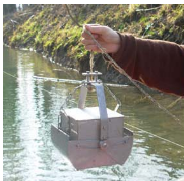
Figure 11: Benne d'Heckmann et échantillons pour l'analyse granulométrique.
