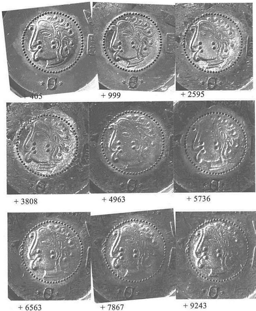
Fig. 15: Usure du coin de droit en bronze en 2007.
