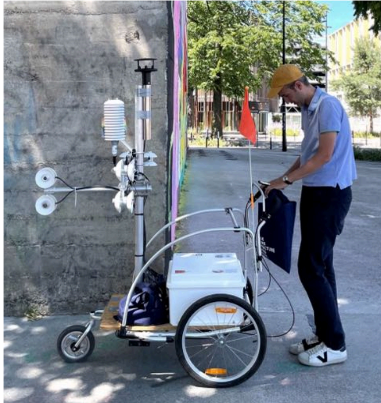
Figure 1: Le chariot climatique développé par notre équipe. On distingue la sonde mixte sous abri (cylindre blanc sur le mât vertical), l'anémomètre ultrasonique (en haut du mât), les couples de pyranomètres et pyrgéomètres dans les trois directions droite/gauche, devant/derrière et haut/bas. Photo D. Siret / I. Requena / AAU-Crenau.
