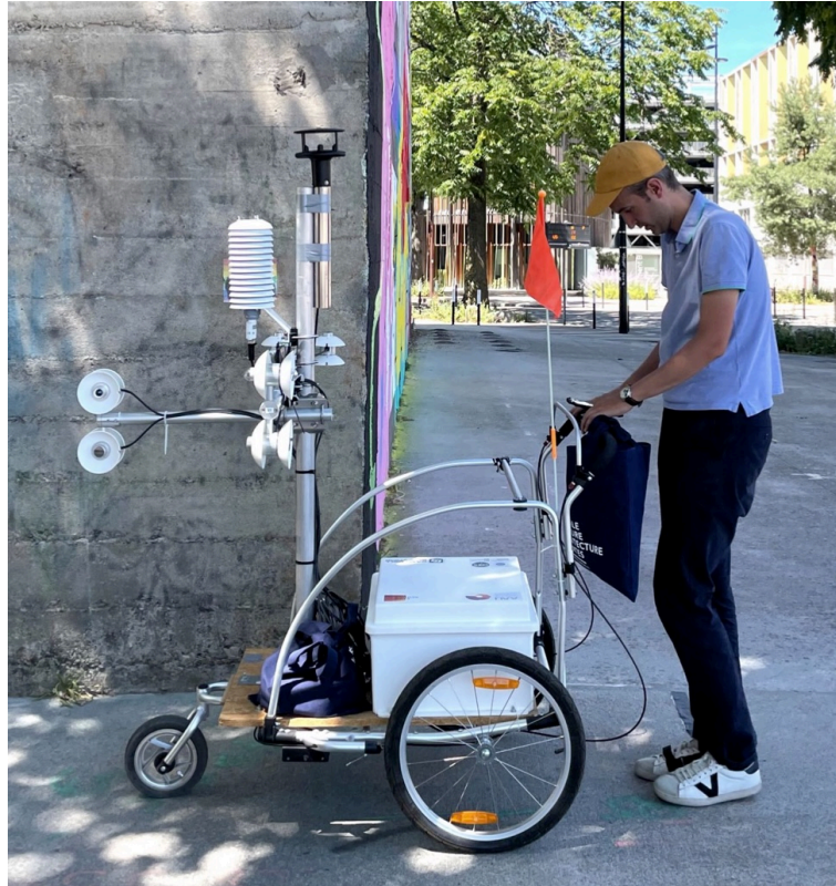
Figure 1: Support mobile de la station météorologique mobile et montage des capteurs
