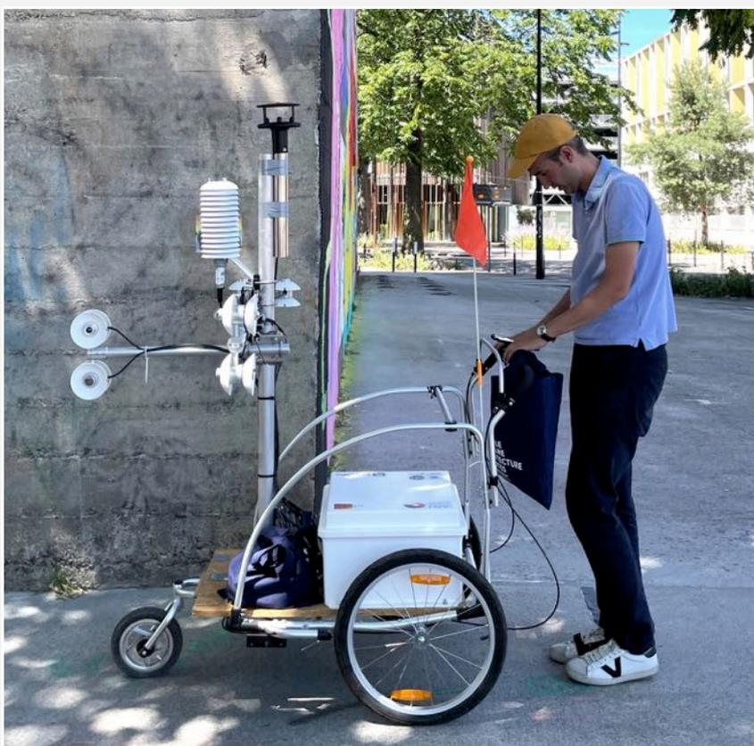
**Le chariot climatique** développé dans le cadre du projet Coolscares mesure en temps réel plusieurs paramètres physiques caractéristiques du ressenti thermique :
