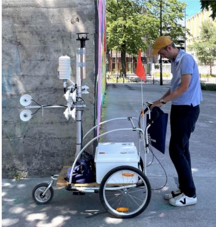
Figure 1: Le chariot climatique développé par notre équipe. On distingue la sonde mixte sous abri (cylindre blanc sur le mât vertical), l'anémomètre ultrasonique (en haut du mât), les couples de pyranomètres et pyrgeomètres dans les trois directions droite/gauche, devant/derrière et haut/bas. Photo D. Siret / I. Requena / AAU-Crenau.
