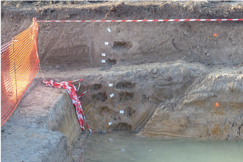
*N° 2 : Emplacement des prélèvements pour analyse granulométrique et Carbone Organique Total*
