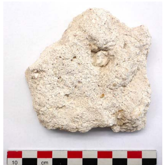
Fig. 3 : Aspect de surface du mortier crayeux.
