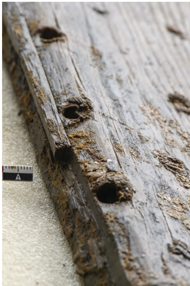
Sl. 12 Detalj oplata broda - pogled na vanjski rub platice P5b s ulomkom grančice (štipića) u utoru sa spojem (fotografija: L. Damelet).
