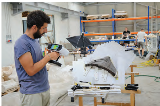
Sl. 10 Skeniranje uzdužnog osnog elementa P2 (fotografija: L. Damelet). Fig. 10 Scanning longitudinal axial timber P2 (photo: L. Damelet).
