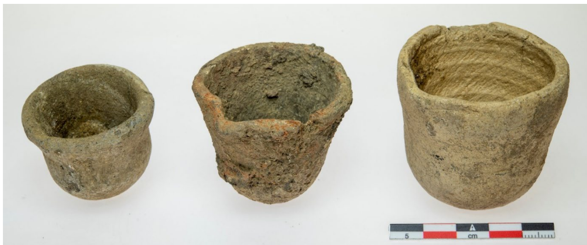
3 creusets intacts issus du corpus des céramiques métallurgiques
