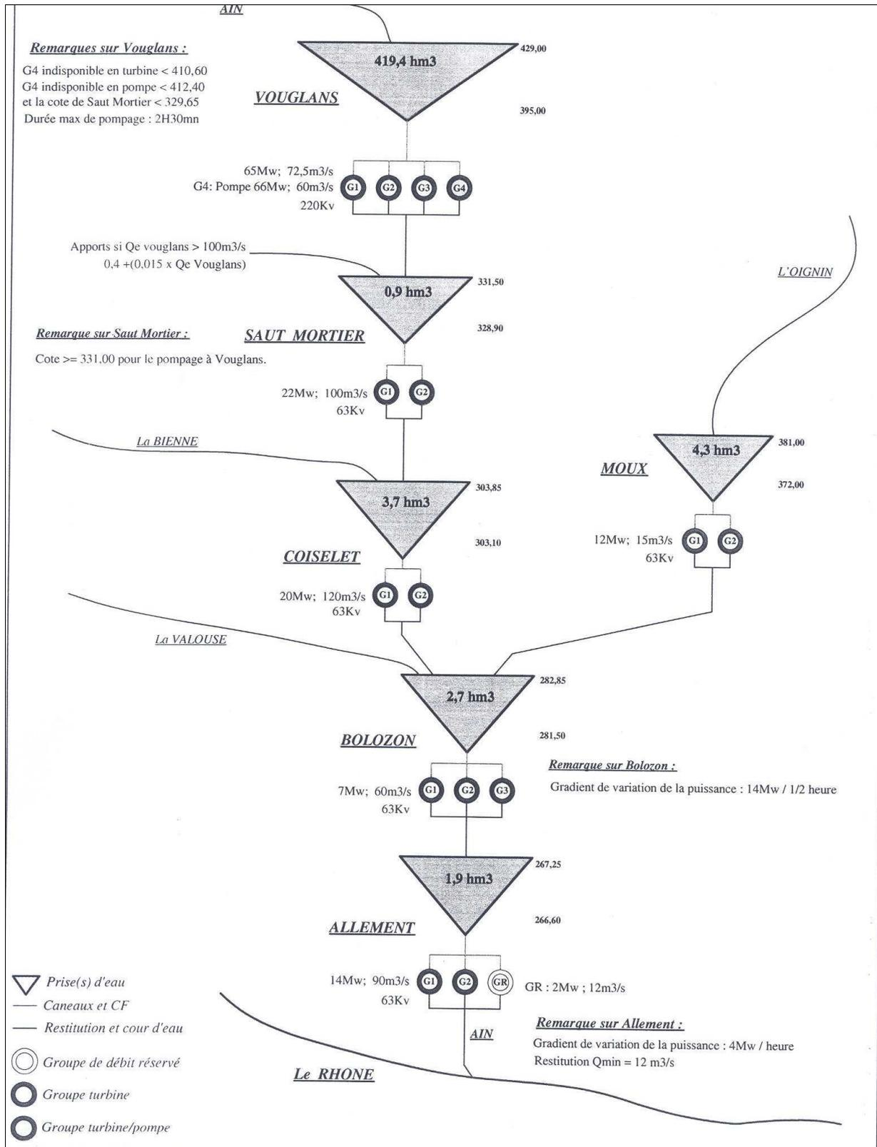
Figure 3 : Schéma hydraulique de la vallée de l'Ain.
