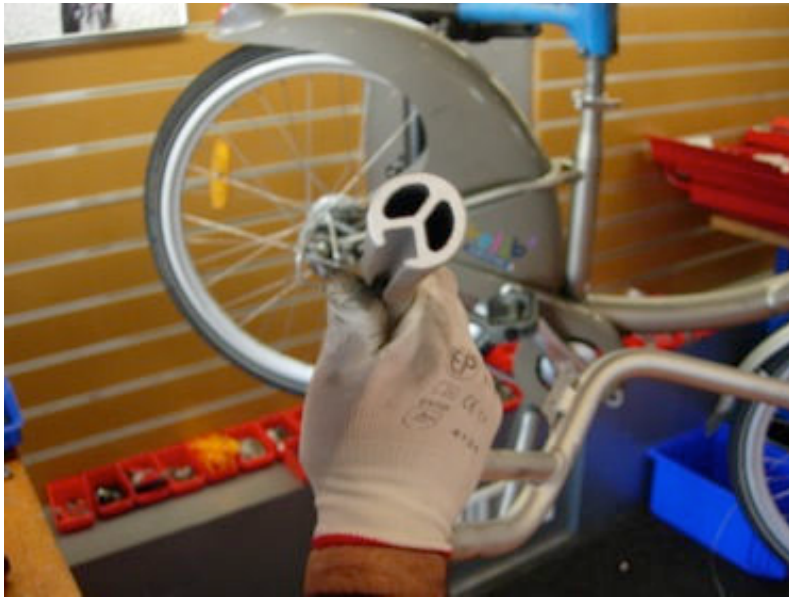
Figure 38 : Tube de guidon renforcé
