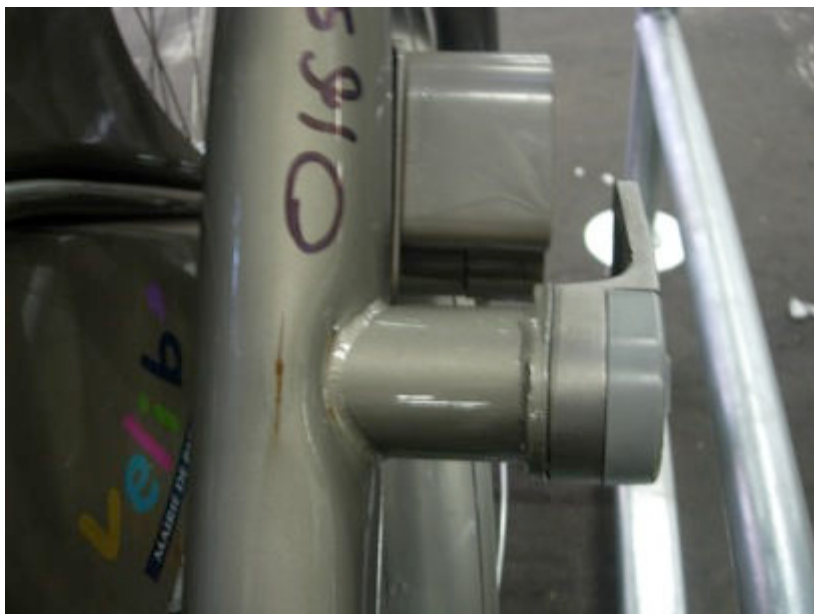
Figure 44 : Vélo avec un cadre abimé non renforcé
