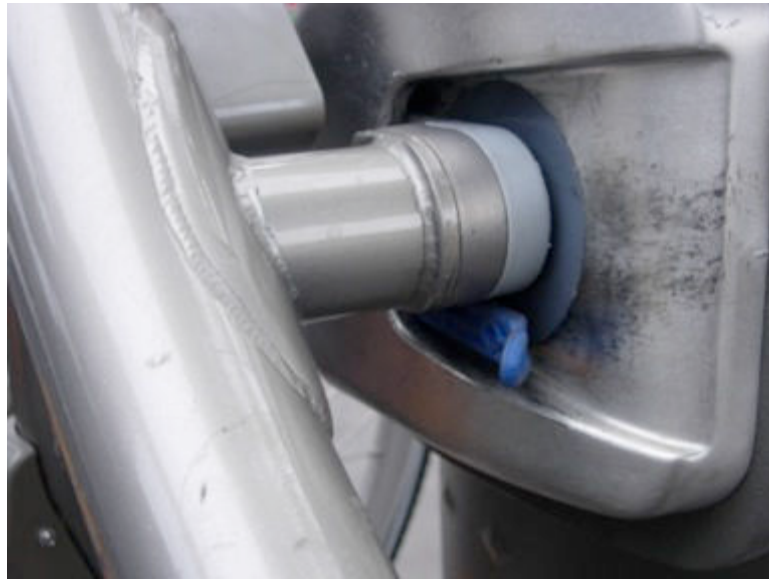
Figure 16 : Un démonte-pneu dans la bornette d'accroche
