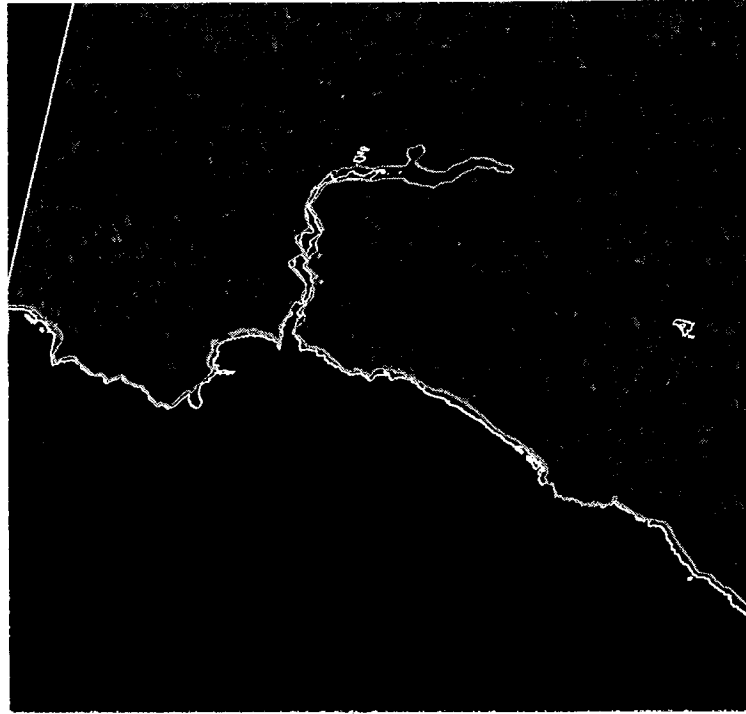
Figure 1-8. Trait de côte défini par seuillage radiométrique sur l'image optique, acquise par Landsat-TM. On constate une bonne détermination du trait de côte, même s'il existe quelques écarts, notamment sur les plages et à l'est de l'image.
