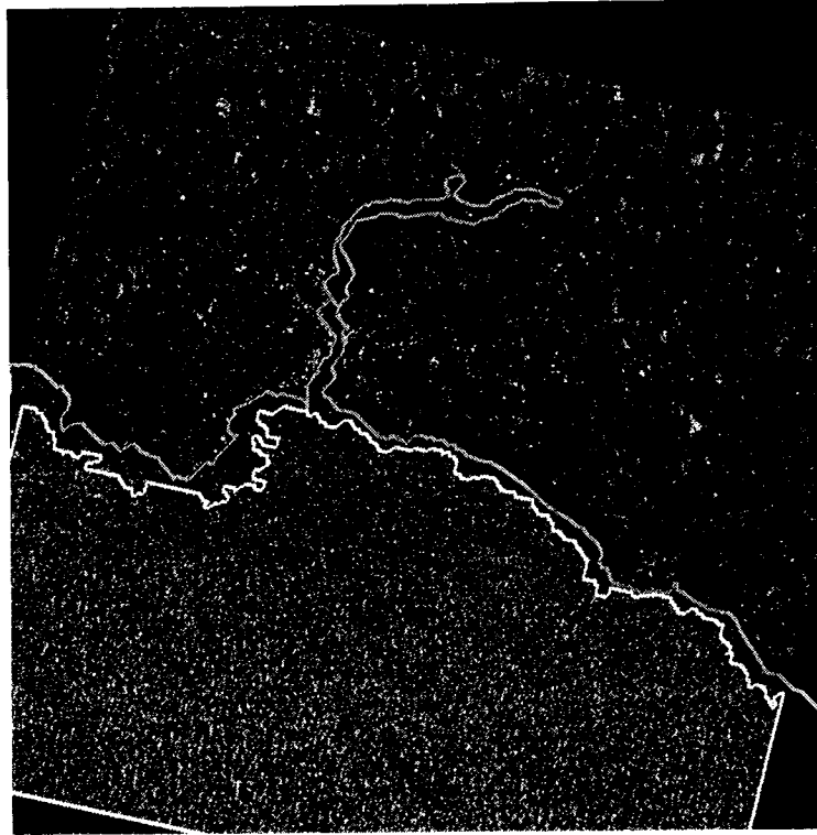
Figure 1-12. Classification terre-mer par l'algorithme de croissance de régions. Le trait de côte paraît continu et assez lisse car nous avons interpolé ce trait à partir de celui obtenu sur l'image 256 \times 256 pixels, pour obtenir une image de 1\,024 \times 1\,024 pixels.
