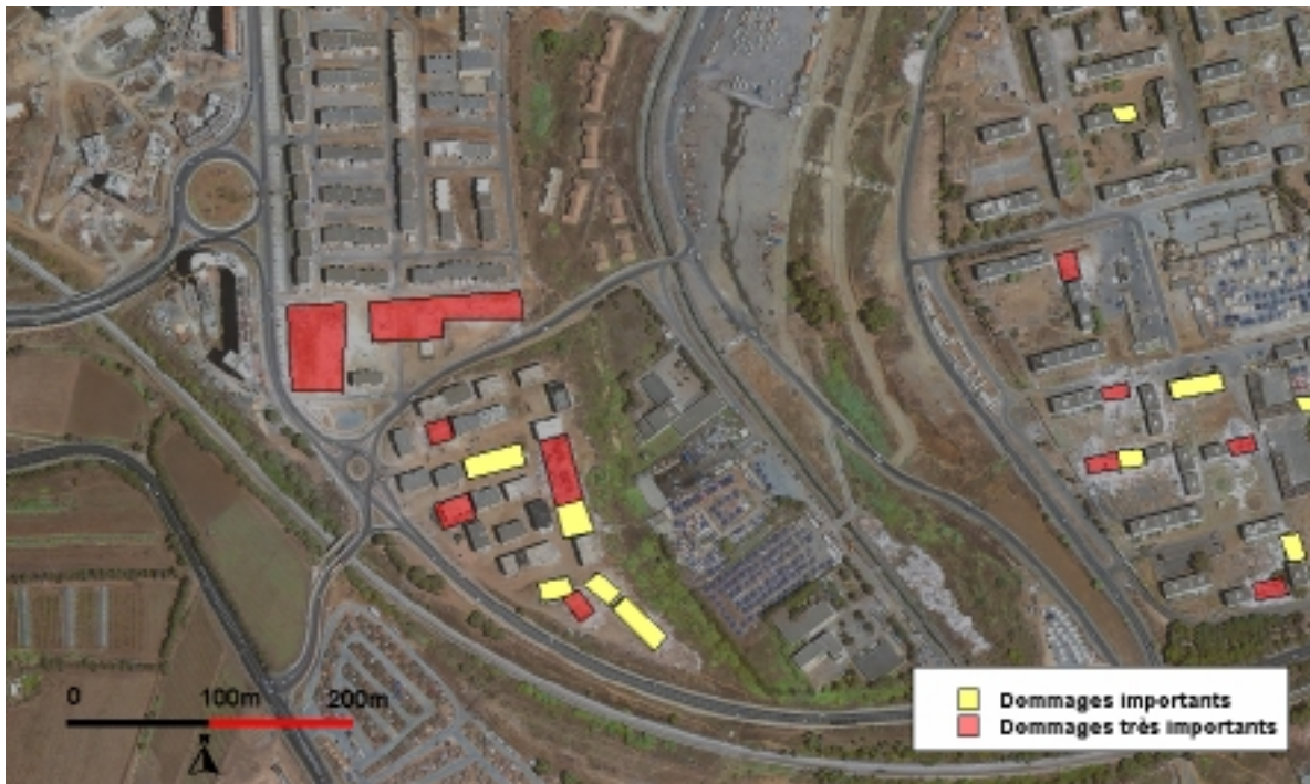
Figure 4.43 Cartographie de dommages sur une partie de ville de Boumerdes, suite au séisme du 21 mai 2003 (source de l'image de fond : DigitalGlobe).
