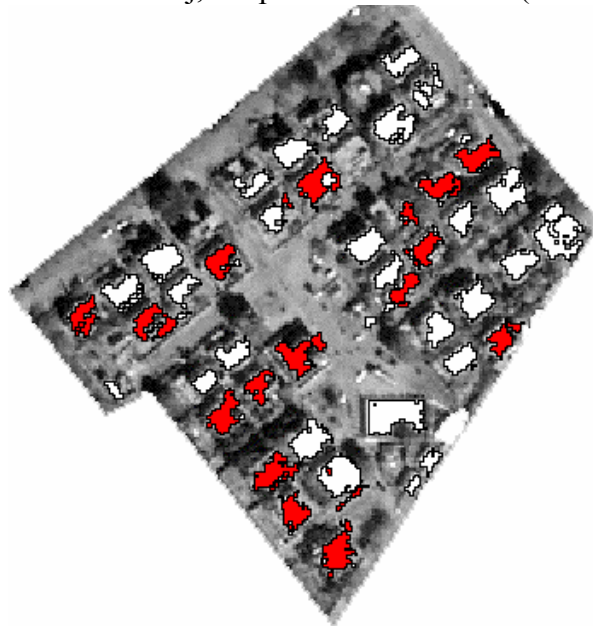
Figure 4.7 Bâtiments endommagés (en rouge) détectés par les seuils réalisés sur les indices de contours et forme (source : André et al, 2003).
