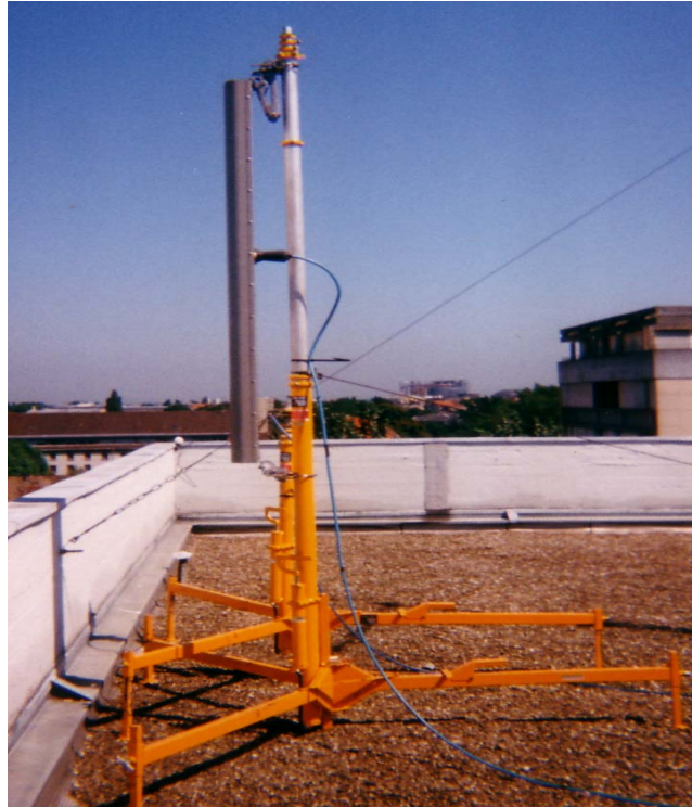
Figure 1.3 : Exemple d'antenne directive implantée au dessus d'un toit d'immeuble (Préfecture du Bas-Rhin) Campagne de mesure COST-CNET2 192
