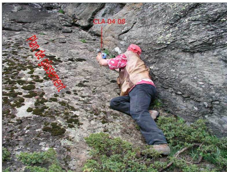
Figure B-41 : Exemple de prélèvement sur un plan de glissement ayant donné lieu à un éboulement (Haute-Clarée, alt. 2040 m).
