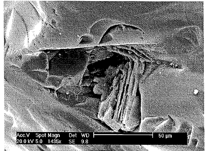
d) I - 10 SM : Multiples traces de chocs sur le pourtour d'une cavité, probablement une inclusion qui a sauté
