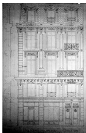
Figure A.20 : Façade d'un bâtiment de la place St Pierre, concours de 1868 et extrait d'un module de façade [AMN 1Fi 29] Taux d'ouverture : 35,75%
