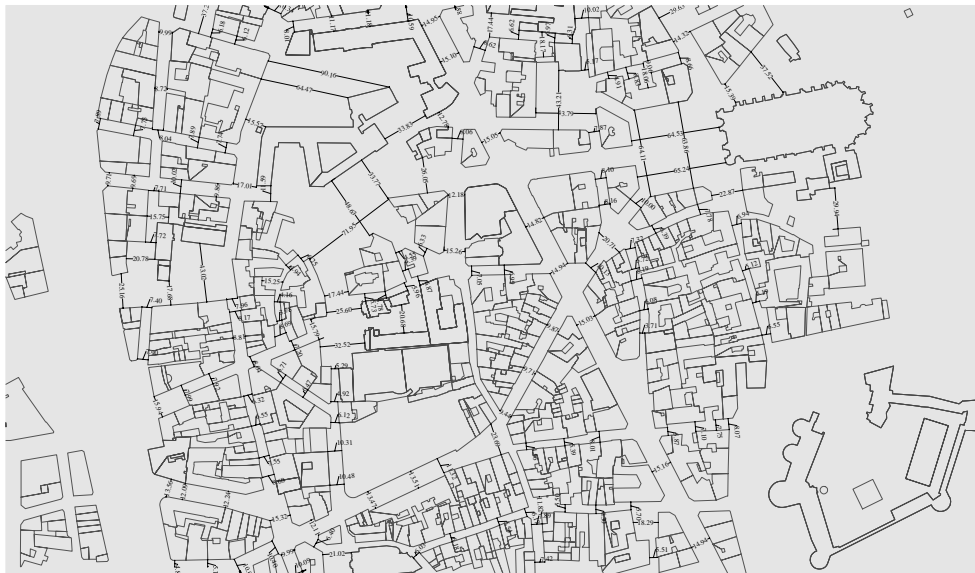
Figure 3.88 : Cotation des largeurs de rues sur le plan numérique de la ville actuelle
