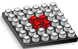
Fig. 95. Pattern de stimulation indiquant la position entre l'axe et les frontières de la zone de tolérance par modulation de la fréquence.
