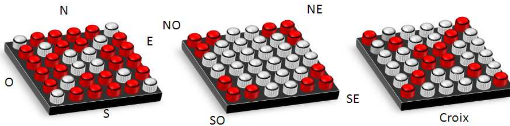
Fig. 29. Schémas des 9 stimulations utilisées pour le codage du guidage par TDU. Les cylindres rouges représentent les électrodes activées et les cylindres gris les électrodes inactivées. A Gauche, N, S, E, O ; au centre, NE, NO, SE, SO ; à droite, la stimulation "croix". Le nord (N) se situe sur la pointe de la langue et correspond à un geste vers l'avant (voir figure 31 à la fin de cette section).
