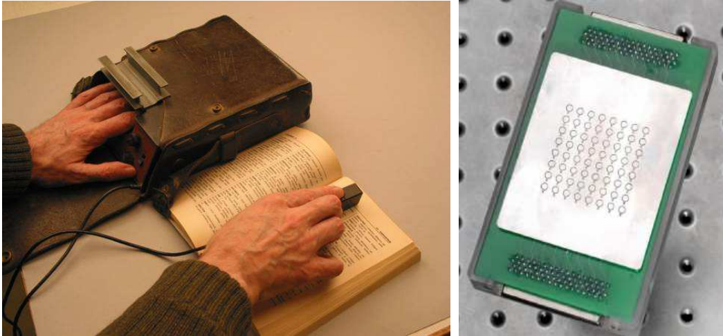
Fig. 22. A gauche, le dispositif vibrotactile "Optacon" (Goldish & Taylor, 1974). Une caméra, dans la main droite, transforme les lettres en stimulation tactile sur les doigts grâce à une matrice tactile de stimulateurs vibrotactiles (main gauche). Un non-voyant pouvait ainsi lire des livres qui n'avaient pas été transcrits en braille. A droite, l'interface vibrotactile "vital" (Benali-Khoudja et al., 2004) constitué d'une matrice 8x8 utilisant une nouvelle technologie de stimulateur : des micros actionneurs électromagnétiques.
