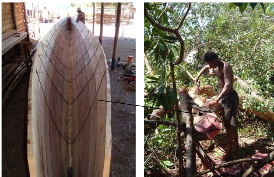
Photographie 82 : Prise de gabarits des membrures sur une pirogue de 12 mètres
