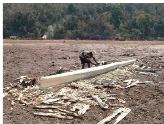
Photographie 95 : A Ambalamanga, taille d'un flotteur en pamba à l'aide du fitoraka
