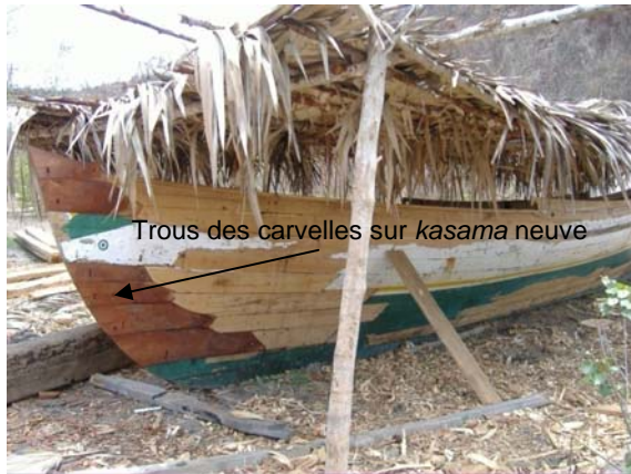
Photographie 89 : Réparations sur une pirogue de transport à Bekobany
