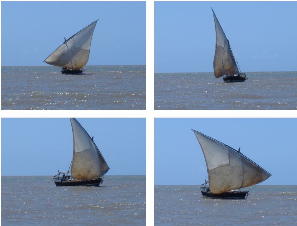
Photographie 102 : Empannage vent arrière d'un boutre qui manœuvre pour rentrer dans le kinga Antsahabingo
