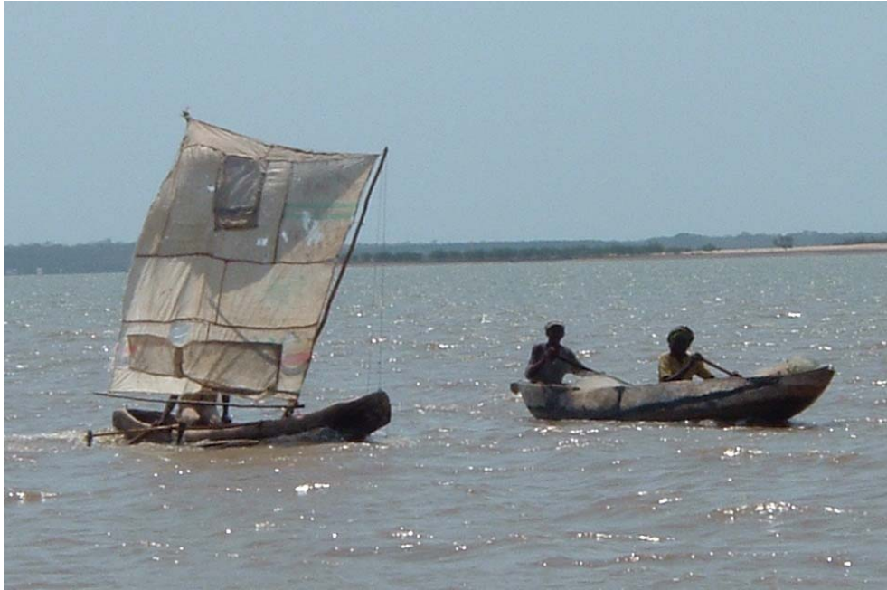
Photographie 103 : Les deux types piroguiers principaux de la baie du Boeny, lakadjilo avec fanary grée d'une voile à livarde et lakadjilo propulsée à la pagaie
