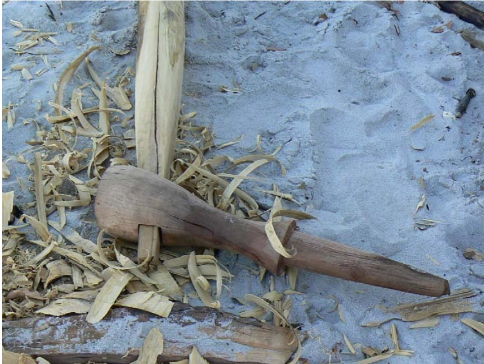
Photographie 91 : Vue de l'ensemble bras de balancier avant (en amaninomby ) et tatiky (en nanto ) reliés par un assemblage de type tenon/mortaise
