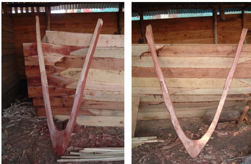
Photographie 86 : Couple assemblé en attente de montage (1)
