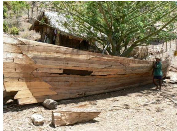
Photographie 78 : Vue de profil d'une coque (quasiment intégralement bordée) d'une pirogue de transport de 12 mètres de longueur
