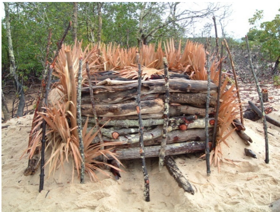
Photographie 121 : A Tsinjorano, four à charbon en construction sur la dune
