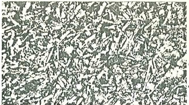
Ech. DF 461 80 (49°57'06" N - 75°12'47"): lave microlitique A: microlite allongé B: microlite trapu C: vacuole. Nous observons pas de canalicule dans les microlites allongés.
