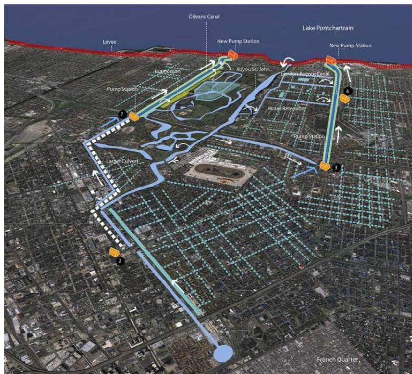
Figure 95. Exemple d'aménagement résilient du point de vue de l'inondation dans le processus de reconstruction de la Nouvelle Orléans : amélioration du système de drainage de surface ([http://www.wbarchitects.com/research/dutch\\_dialogues/](http://www.wbarchitects.com/research/dutch_dialogues/))
