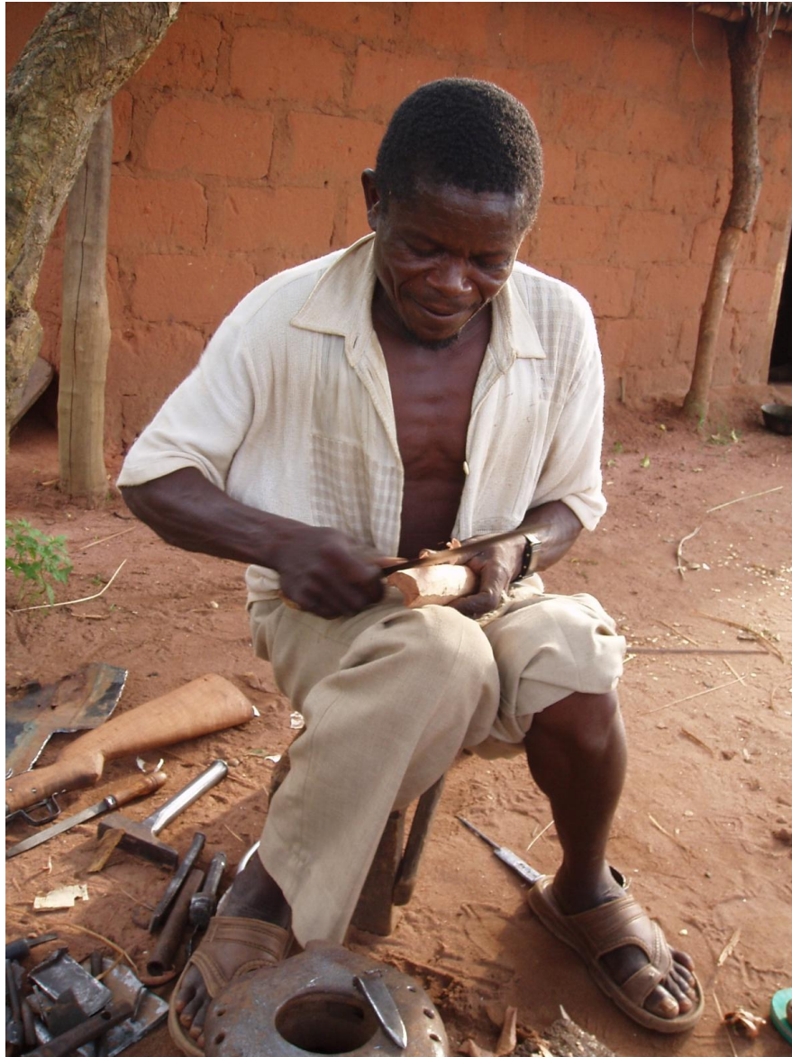
Photo 15 : La fabrication de la crose
