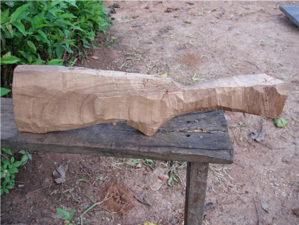
Photo 8 : La fabrication de la crose
