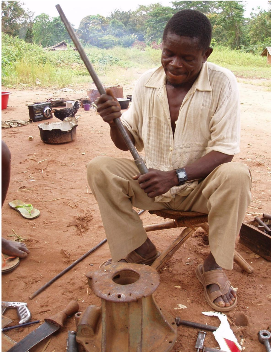
Photo 14 : La fabrication du canon
