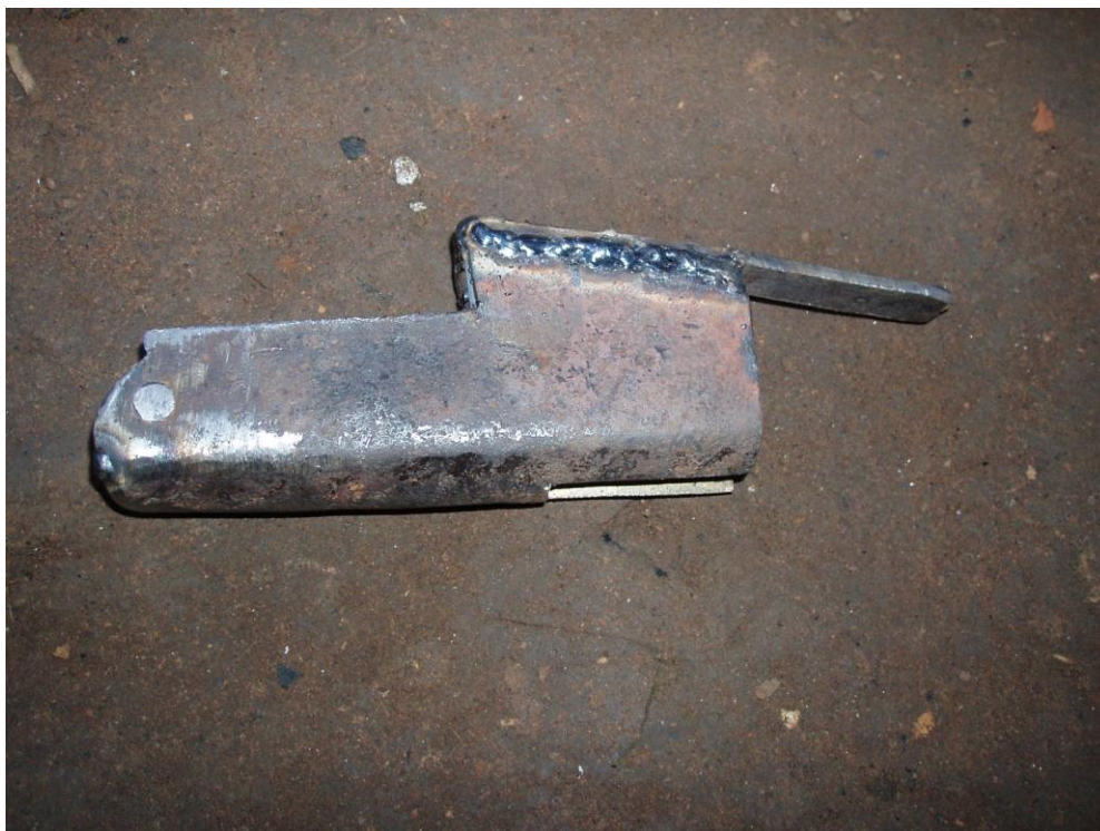
Photo 7 : Le bloc culasse soudé
