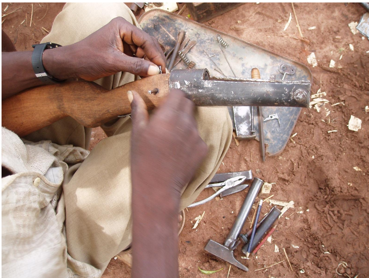
Photo 16 : L'ajustage de la culasse
