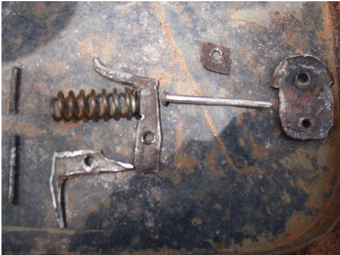
Photo 18 : Détails du mécanisme de percussion
