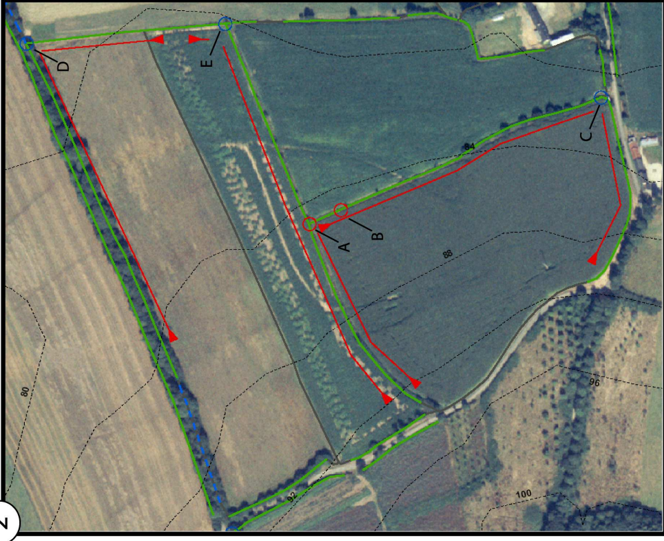
2 Modélisation de l'effet des talus sur les écoulements de surface
