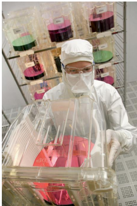
Figure B : opérateur en salle blanche maniant les plaques de silicium
