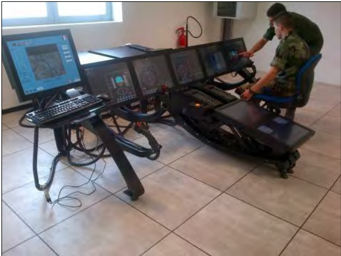
Figure 4. Part Task Trainer « enhanced » NH 90 Caïman.
