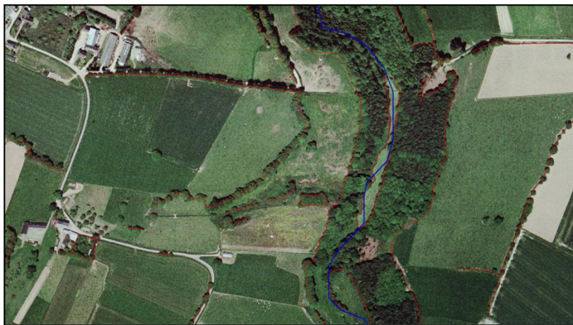
Figure 42- Exemple de digitalisation du linéaire bocager à partir d'une photographie aérienne
