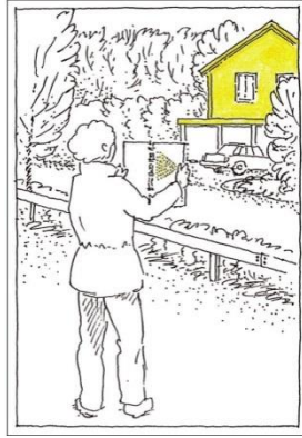
Figure 55, Méthode de relevé des couleurs à distance selon Karin Fridell Anter 260 « Une manière de déterminer la couleur perçue d'une façade est de la comparer aux échantillons de l'atlas NCS » 261
