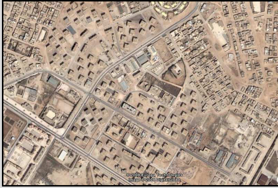
Photos -561- et -62- Cité 5 juillet – opération Z.H.U.N. bâtiments implantés selon le principe du « chemin de grue », sans logique apparente Photo -62- Bachar k. 2008
