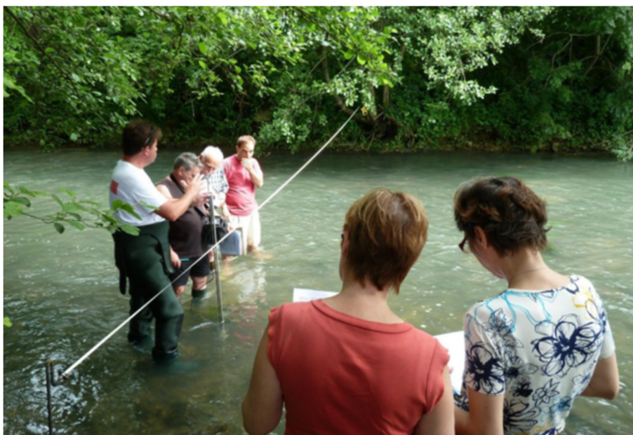
Figure 55 : Mesure de débit à l'aval du clapet de Mouroux, pendant la sortie de terrain de juin 2012.
