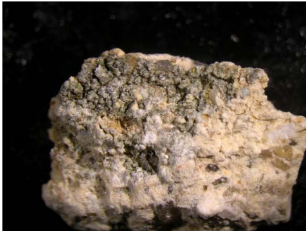
Abb. 1498.Probe 01.1: Aufsicht auf die mit Flechten bewachsene Mörtelprobe (LM).
