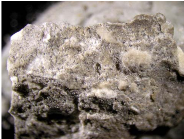
Abb. 1498.Probe 09.1: Aufsicht auf die von Gips überzogene Oberfläche (Restaurierungsmörtel)
