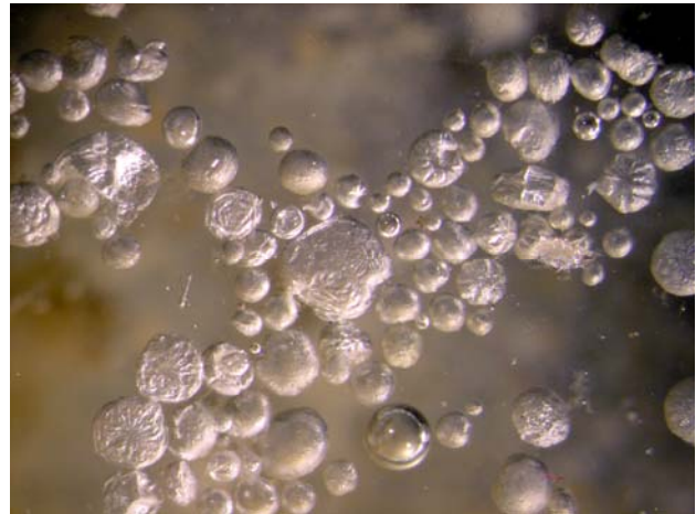
Abb. 1498.Probe 06.2: Stabile Bläschenbildung durch organischen Zusatz im Bindemittel.
