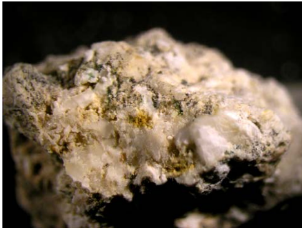
Abb. 1498.Probe 05.1: Aufsicht auf die mit Flechten bewachsene Bruchfläche des körnigen Kalkmörtels mit braunen Einschlüssen (LM).
