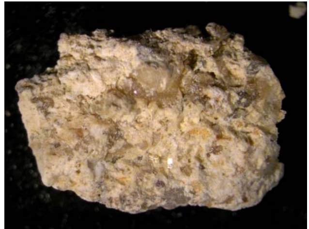
Abb. 1498.Probe 01.2: Aufsicht auf die von Klüften durchzogene Unterseite der ockerfarbenen Matrix.
