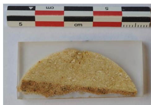
Figure VII-29: Photo macroscopique de lame épaisse de l'échantillon BDX 16587 avec l'interface entre le mortier et la pierre.
