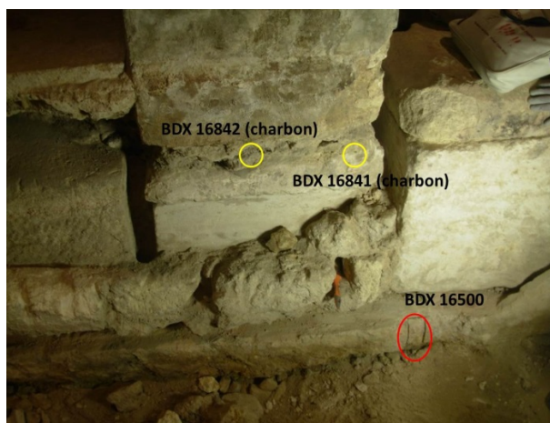
Figure VII-9 : Prélèvements dans la zone 2. Le mortier de tuileau BDX 16500 (en rouge) représente le mortier de pose du sol de terres cuites de la fosse centrale, sur lequel reposent les trois sarcophages. Les charbons (en jaune) ont été prélevés dans le mortier gris dans le niveau entre le cénotaphe et le sarcophage.
