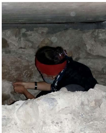
Figure II-2 : Prélèvement à l'aide du marteau et du burin
