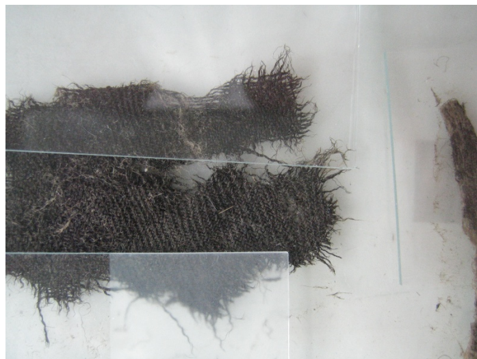
Fig. 6 : Durant l'évaporation de l'eau, des lamelles de verre maintiennent les bords afin d'éviter les soulèvements.
