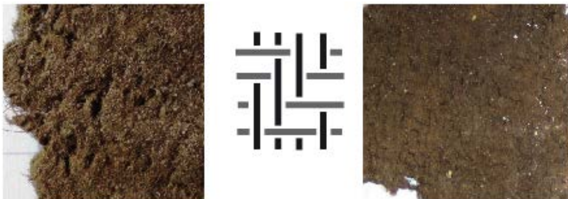
Fig. 69 : deux qualités de drap base sergé de 2 lie 2 (038.152 du groupe 203, grossier, et 026.019 du groupe 149, moyen ; les contours des photographies mesurent 2 cm).
