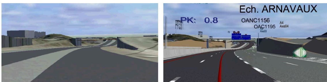
FIG. 5.11 – Mise en évidence de la différence du niveau de conception entre la phase AVP et PRO. /projet L2
