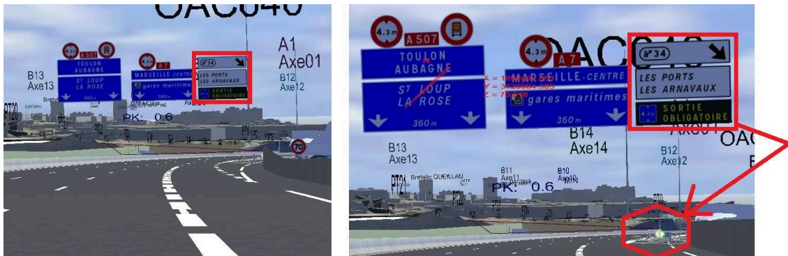
FIG. 7.20 – Exemple de non respect de la visibilité simultanée à distance réglementaire, fonction de la vitesse de circulation, sur le panneau de sortie (sortie 34, panneau de type D31) et sur la balise de divergent (balise verte, type J14, entourée en rouge en bas à droite de l'image de droite : elle n'est pas visible sur l'image de gauche à la distance réglementaire). Extrait de la MN d'avant projet. On remarquera l'absence des porteurs de ces panneaux dans cette modélisation.
