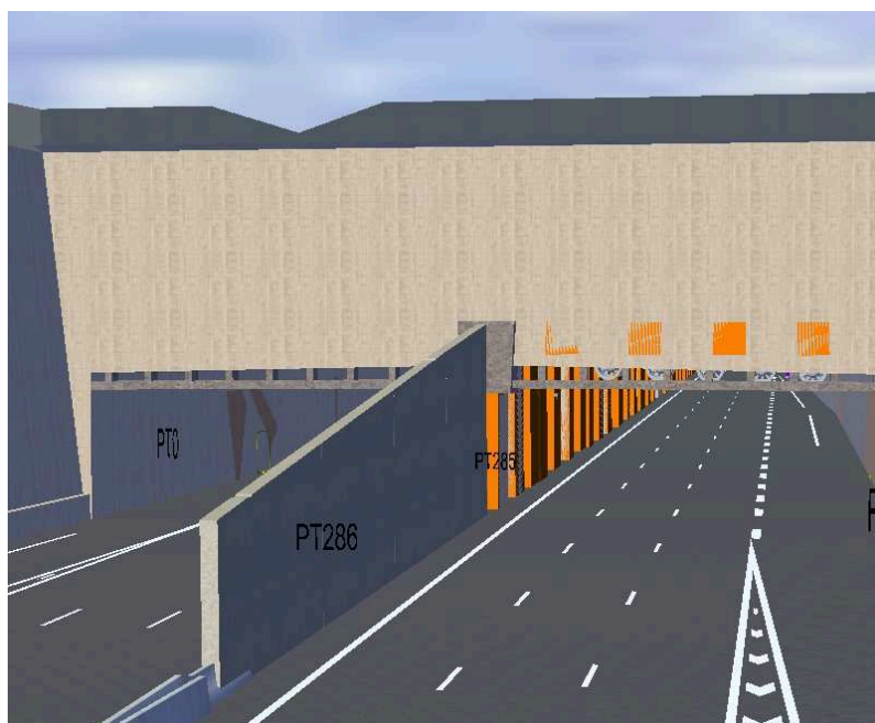
FIG. 8.14 – Exemple de modélisation d'un mur anti-recyclage.
