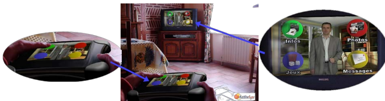
Photo 6 : Dispositif Activage comprenant des services internet (jeux, messagerie, banque de photos, infos diverses) consultables sur la TV par une télécommande accessible et par un Avatar servant de guide.
