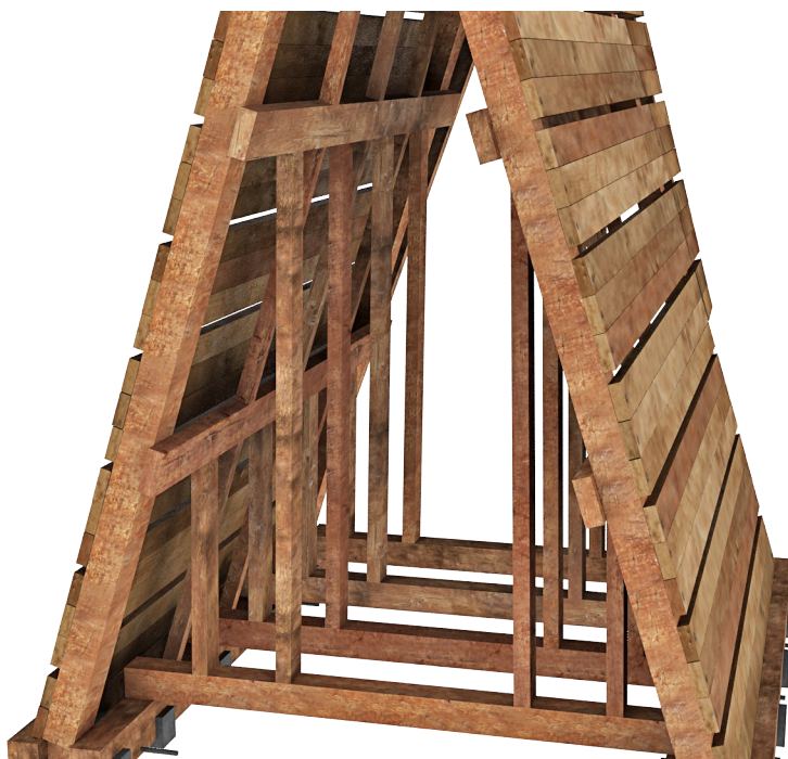
Figure 64 : Traverses et montants de la tortue-bélière
