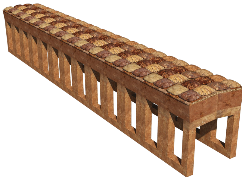
Figure 102 : Galerie construite avec des poutres d'un pied de section et couverte avec des poutres de deux pieds de section
