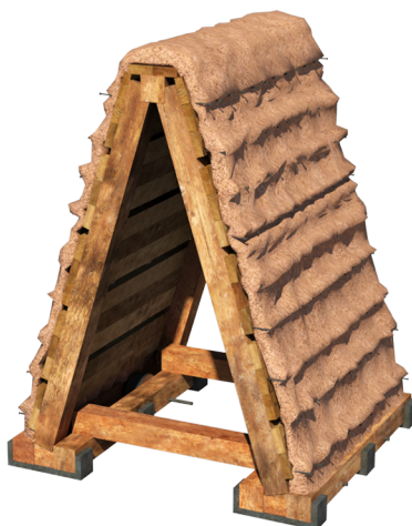
Figure 70 : Tortue de service pour la circulation des hommes
