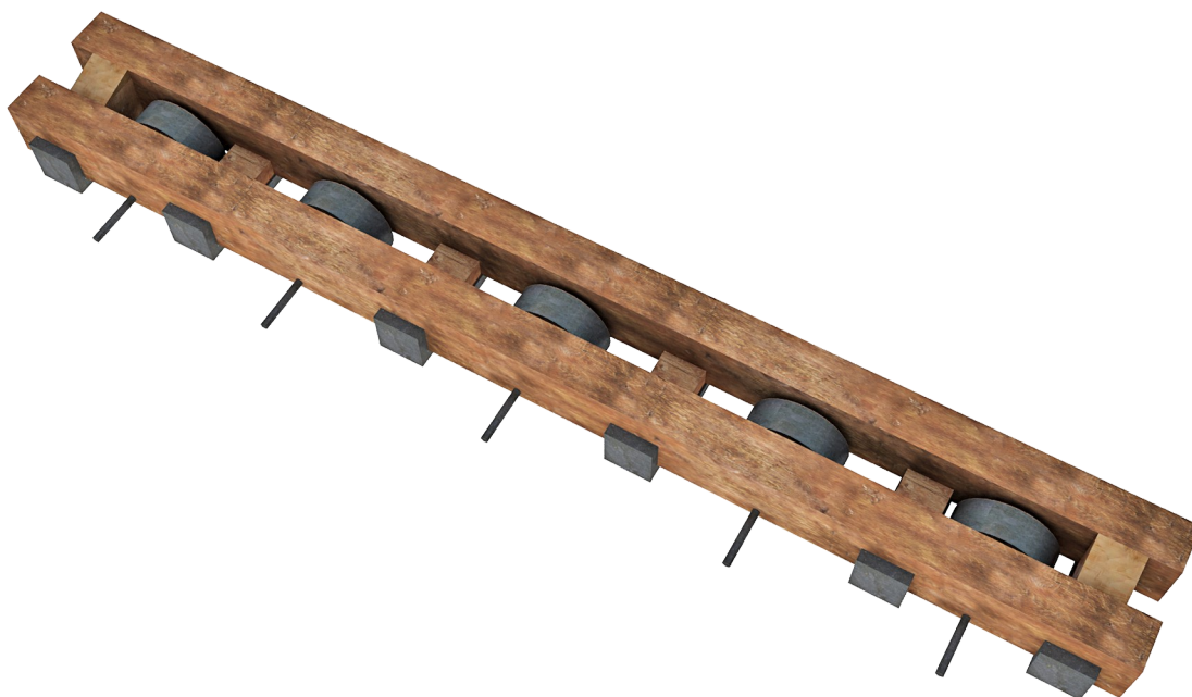
Figure 63 : Système de fixation sur la tortue-bélière
