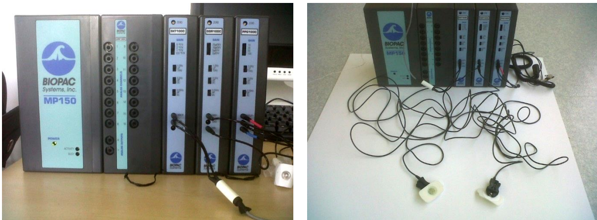
Figure 117 – Système d’acquisition BIOPAC MP150 avec amplificateur GSR100C et PPG100C, et électrodes EL507»
