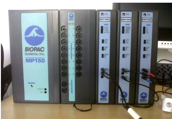
Figure 106 - Système d'acquisition de données BIOPAC MP150, Amplificateur GSR100C et Electrodes EL507»
