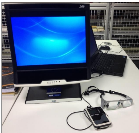
Figure 67 – Eyetracker fixe et mobile (tirée de http://certesens.univ-tours.fr/ )
