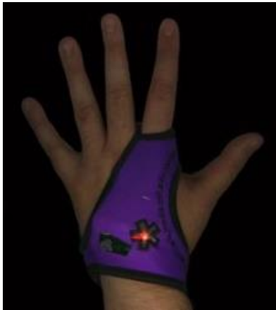
Figure 72 – Gant « Galvactivator » , mesurant la conductivité de la peau (Picard & Scheirer, 2001).
