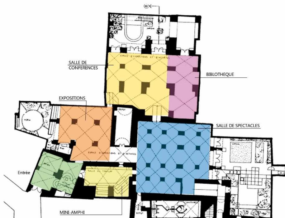
Figure VII-2: Plan du Makhzen de Dar Lasram après reconversion
