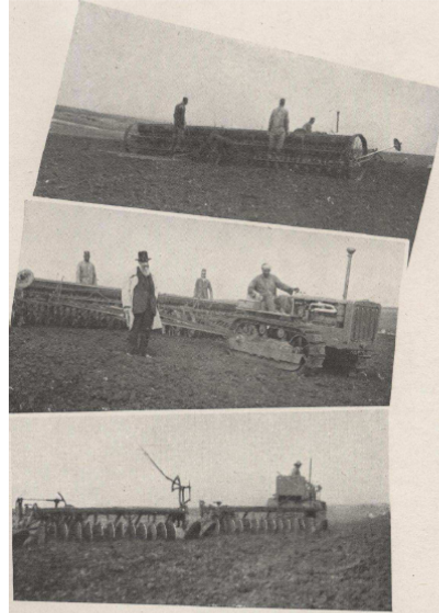
Semoir à grand rendement de 8m50, trainé par un tracteur Holt : a permis de semer 43 hectares dans une seule journée. Deux multidisques de quatre mètres chacun entraînés par un tracteur.
