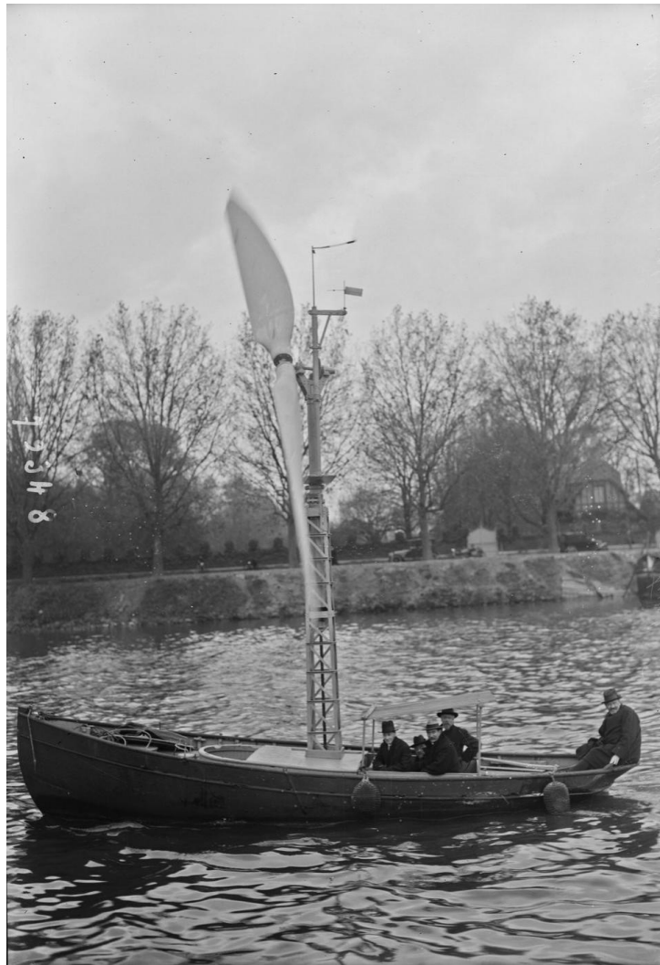
FIGURE 5.9 – Le Bois-Rosé, bateau de pêche équipé d'une « turbine aérienne Levasseur » bipale de 9 m de diamètre, sur la Seine, le 4 novembre 1922 57
