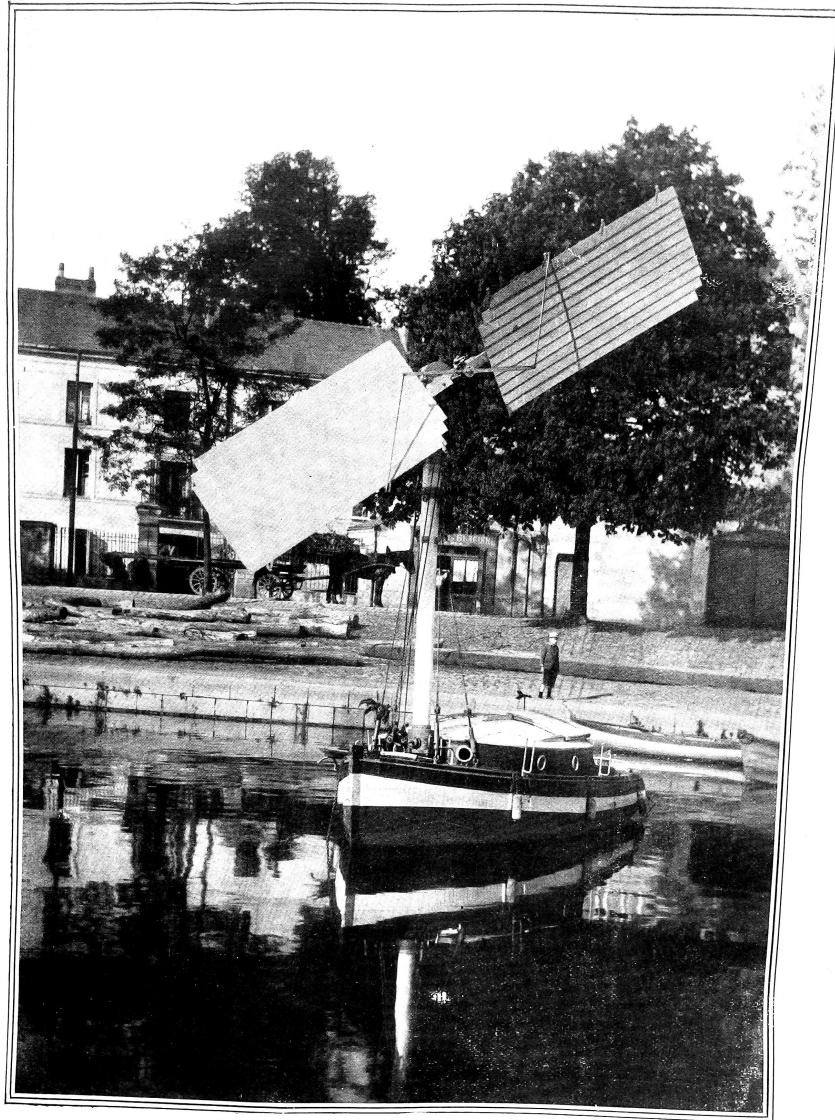
FIGURE 5.3 – La « Drésinette » de Raymond Joëssel : « ancien petit sloop » muni d'un aéromoteur bipale, sur l'Erdre, en 1918 (JOESSEL, 1922, p. 14)
