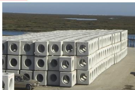
Photo 6 : Modules dédiés à la protection et à l'accueil de juvéniles (photos IPIMAR)
