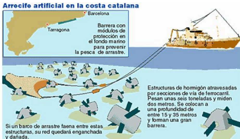
Figure 3 : Principe d'utilisation des RA de lutte contre le braconnage de chaluts illégaux dans les zones côtières destinées à la pêche artisanale (e.g. en Catalogne extrait du quotidien « El País », Espagne, 2003)
