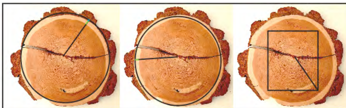
Figure 39 : Présence d'aubier sur un échantillon. A gauche, l'échantillon a conservé un fragment d'écorce (aubier complet). Au centre, une partie de l'aubier est conservé. A droite, l'équarrissage du bois a fait disparaître l'aubier, seul le duramen est conservé. DAO de V. Labbas.
