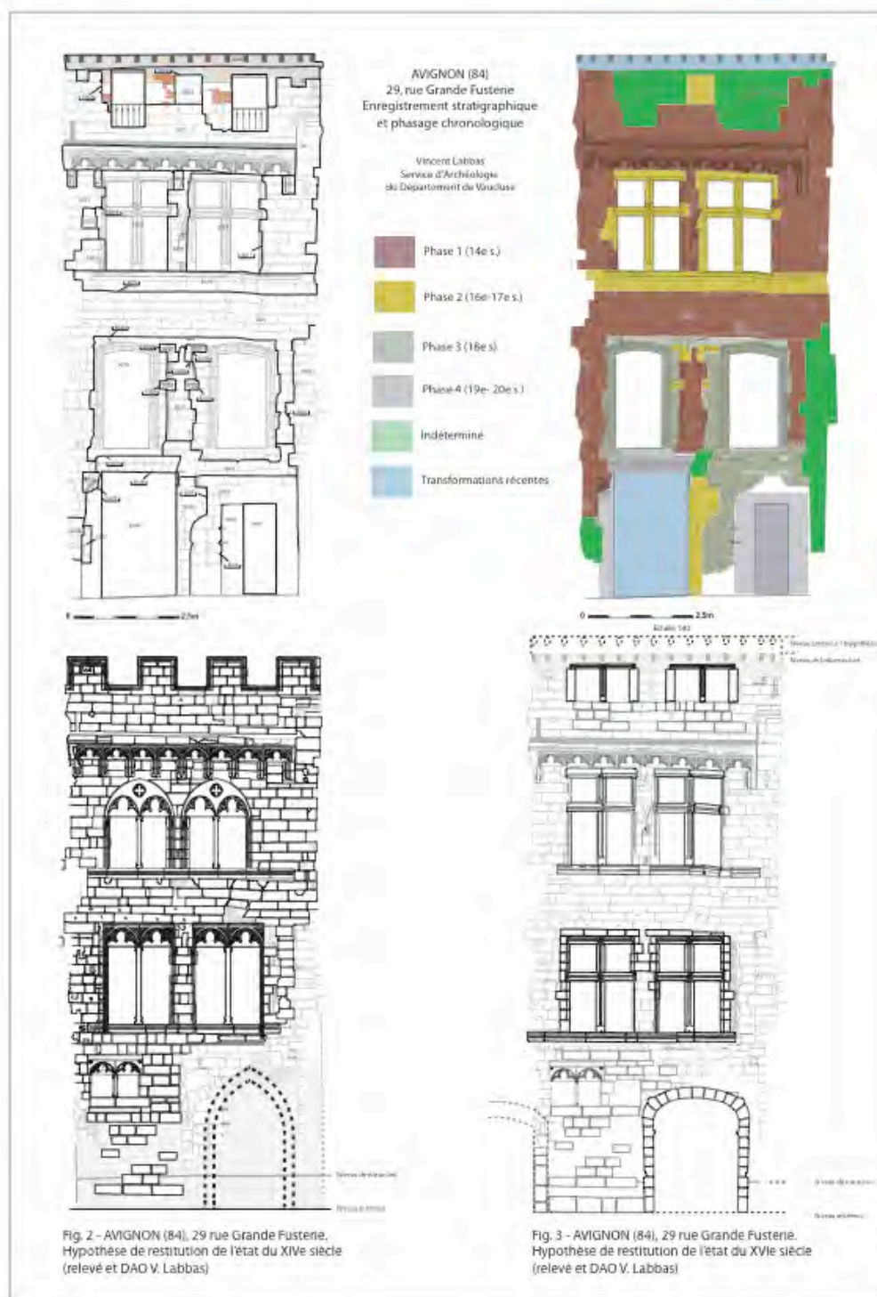
Figure 38 : Exemple d'un phasage chronologique obtenu par stratigraphie d'une façade. L'association des éléments stylistiques et la restitution d'éléments formels permettent de proposer des restitutions phasées. DAO de V. Labbas (d'après Labbas, 2011).
