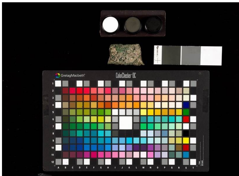
Figure C.2 24 – Protocole suivi pour la prise de vue en studio photo. Une charte couleur est utilisée pour la calibration. Image : A. Maigret, C2RMF, 2018.
