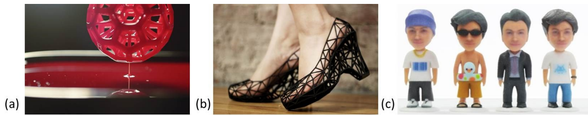
Figure B.1 2 – Exemples d’imprimés 3D. Objets imprimés par (a) le procédé CLIP et (b) le procédé FDM. Images : 3dnatives.com. (c) Personnages colorés imprimés par Binder Jetting. Image : sculpteo.com.
