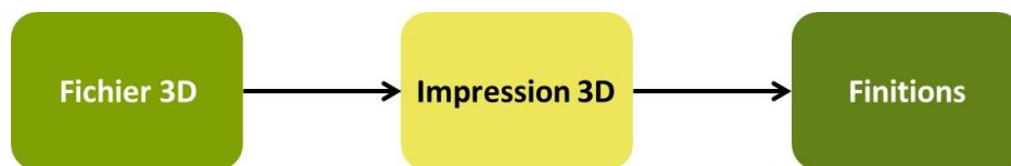
Figure B.1 1 – Etapes de l'impression 3D. Le fichier 3D peut être issu d'un scan, ou créé numériquement sur un logiciel de Conception Assistée par Ordinateur (CAO).
