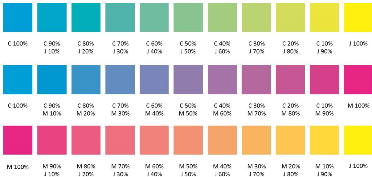
Figure B.4 19 – Chartes utilisées pour l'étude des mélanges à deux encres. La couverture en encre est fixe à 100% ; ce sont les pourcentages respectifs d'encres colorées qui varient.
