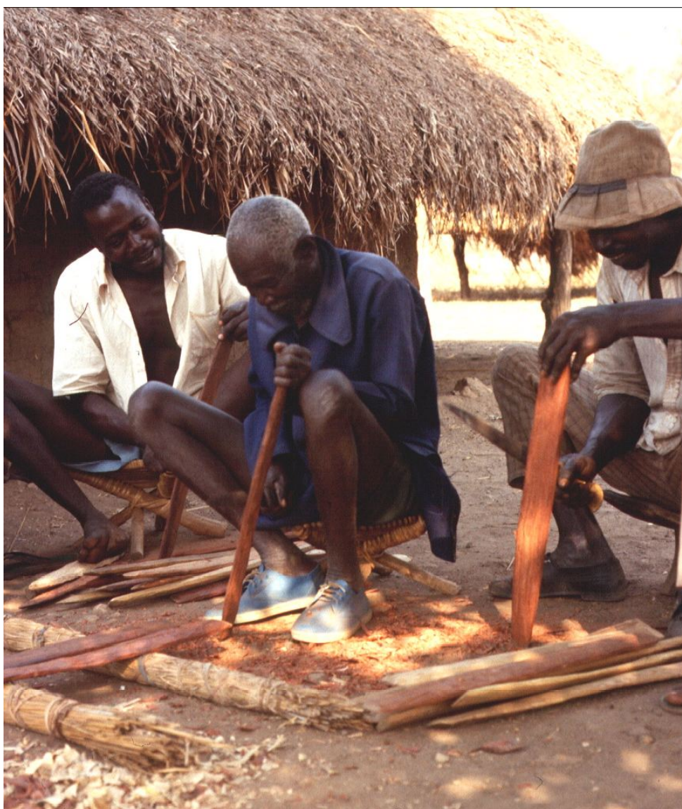
Photo 2 : Mise en forme des lames des différents xylophones par Joseph Yadéré et ses assistants. Photo : Sylvie Le Bomin
